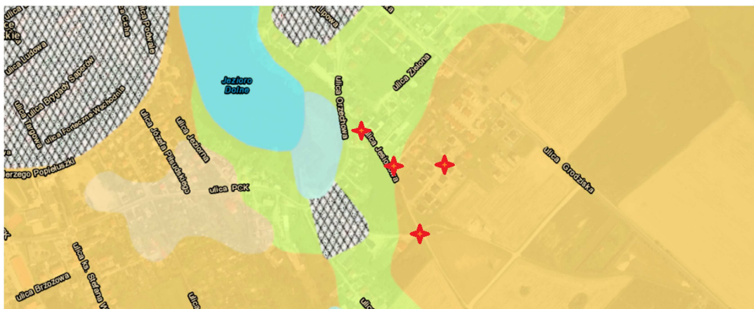
Rys. 1.1. Mapa geologiczna omawianego terenu 1 kolor jasno brązowy – piaski i żwiry lodowcowe, 2 kolor brązowy – gliny zwałowe, 3 kolor zielono-żółty – piaski wodnolodowcowe, 4 kreskowanie – nasypy i grunty antropogeniczne, 5 oznaczenie gwiazdki ✧ – lokalizacja wykonanych otworów wiertniczych).
